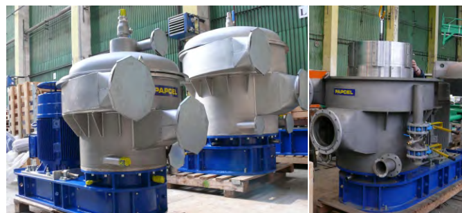
STU-081-L s víkem pro efektivní odvodu látek a třídění nejlehčích nečistot; STU-201; instalace rotoru
