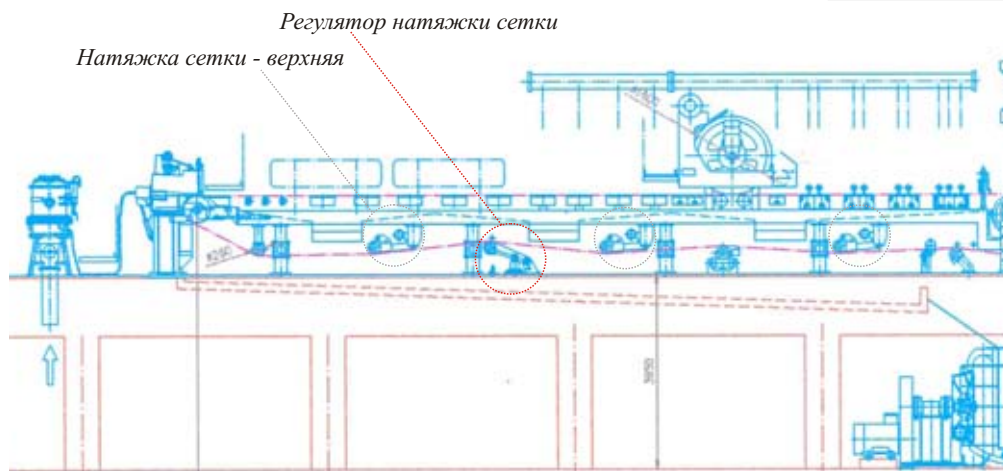
Пример - схема установки оборудования в бумагоделательной машине
