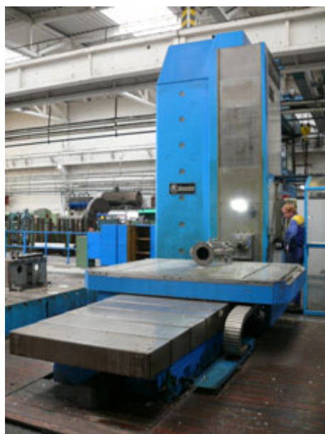
Seřízení geometrie horizontální vyvrtávačky FCW 150 Horizontal boring machine FCW 150 alignment
