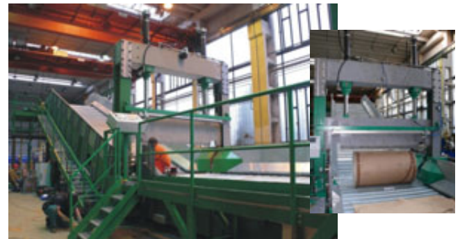
Nové řešení dopravních systémů a sekaček odpadových rolí papíru / New solution of conveyor systems and guillotines
