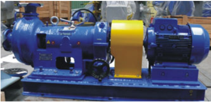
Dovláčkovač D10-D (optimalizace konstrukčního řešení stroje, snížení výrobních nákladů) / Deflaker D10-D (optimization of machine design, reduction of production costs)
