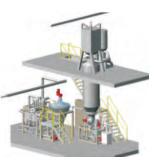
Vařáky pro termochemickou konverzi nativních škrobů pro klížíci lisy a film lisy řady TCC (výkon 300 - 1500 kg/h)
