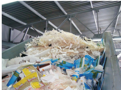
Bílý tetrapak z obalů od mléčných výrobků - zanášení tetrapaku do rozvláknovače
