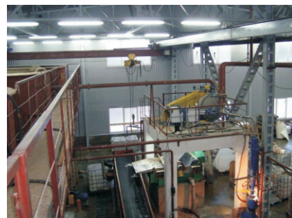
Uzel hrubého třídění (SVS-20, VSV-30, VP-19) s dopravníkem fólií
