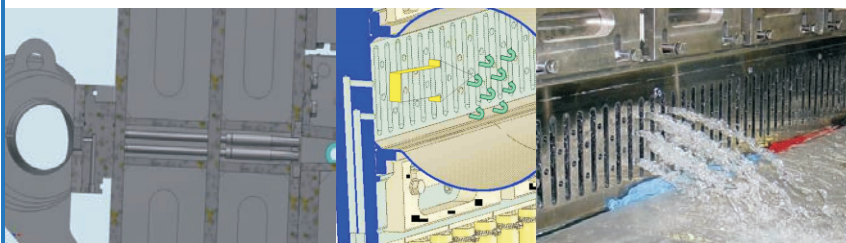
Princip řízení příčného profilu pomocí ředící vody
