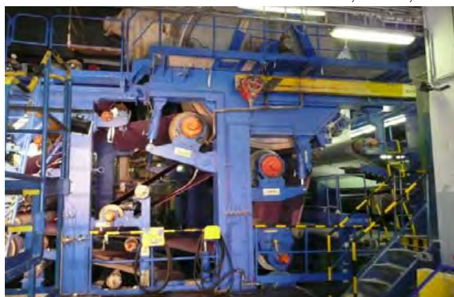
Lisová část + sušicí část (Yankee válec, průměr 4 000 mm)
